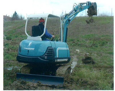
M-35 AVEC PROTECTION OPERATEUR EN PHASE DE TRAVAIL
