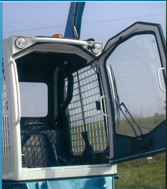
Cab with front door (optional), 1st or 2nd Stage FOPS, ROPS protection / Kabine mit Tür (Sonderzubehör), ROPS FOPS 1st and 2nd Stage / Кабина с передней дверью (опция), ROPS, FOPS 1-го и 2-го уровня
