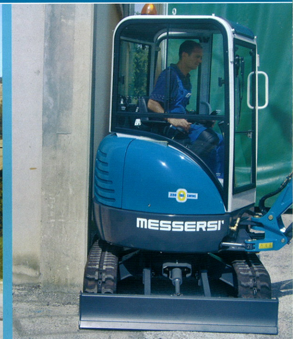
Detail of the rotation of the machine (zero tail swing) / Detail der Rotation innerhalb des Maschinenprofils (Zero Tail Swing) / Изображение разворота контура машины (нулевой размах задней части)
