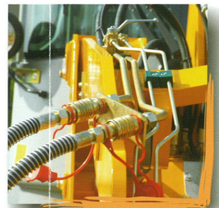
Zusatzanschluß für hydraulische Anbaugeräte z.B. Betonmischschaufel o. Kehrmaschine
