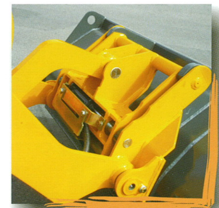
Bei PAUS Serie: hydraulische Schnellwechseleinrichtung für viele Anbaugeräte
