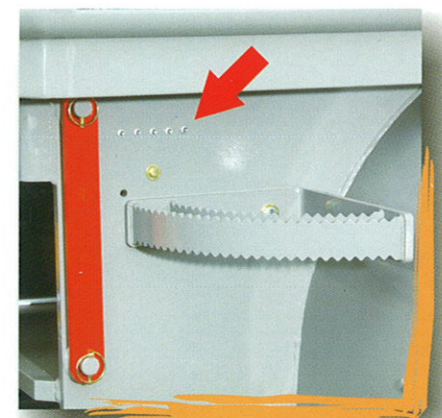
Die zentrale Leiste im Aufstiegsbereich ermöglicht die bequeme Schmierung des gesamten Hinterwagens
