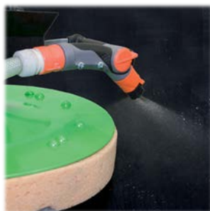
Direktes Befeuchten durch Sprühnebel
