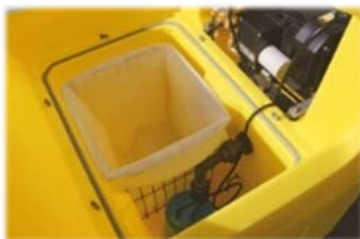
Filtersystem, Tauchpumpe und Hochdruckpumpe
