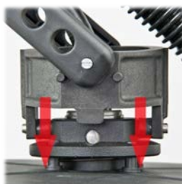
Federnd gelagerte Absaughaube verhindert Rillenbildung beim Ansetzen und gleicht Unebenheiten aus
