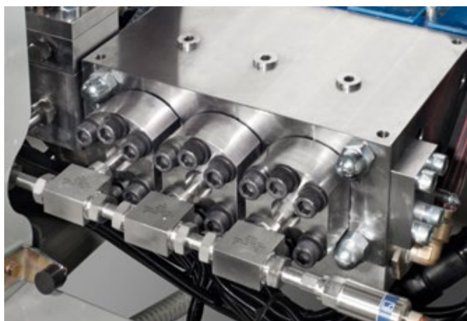
Mehr Leistung und Sicherheit: Höchstdruckpumpe mit Vollhubsicherheitsventil.
