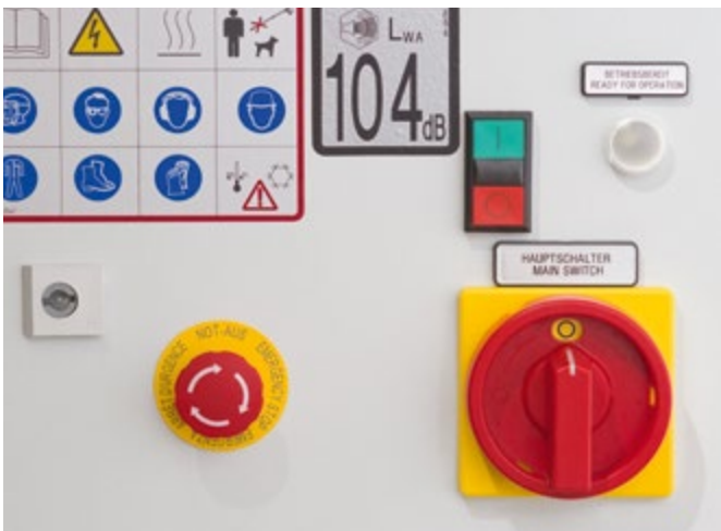
Sicherheit und Komfort: intuitive Steuerung, Sicherheitsventile und Notausschalter.
