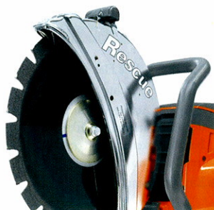
Bei Rauch und Wasserdampf sichtbarer verchromter Scheibenschutz, erleichtert die Trennschleiferkontrolle.
