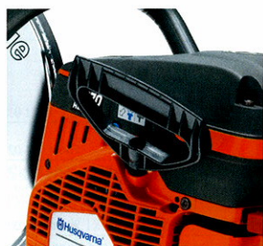
Speziell geformter Startergriff mit Platz für dicke Schutzhandschuhe.
