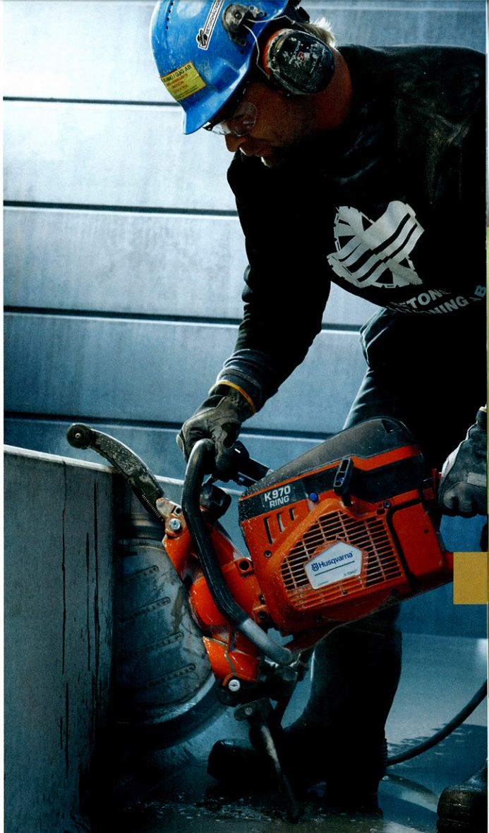
260 mm Schnitttiefe, zweifache Tiefe einer herkömmlichen Trennscheibe.
